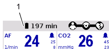
Fig. 3-15 Timpul de funcționare rămas în condițiile de funcționare din acel moment
