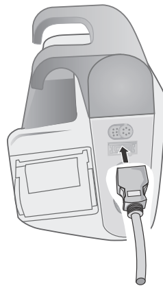
Figura 10-3 Conectarea senzorului de SpO 2 la unitatea X Series
