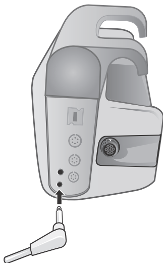
Figura 12-1 Conectarea sondei de temperatură la unitatea X Series
