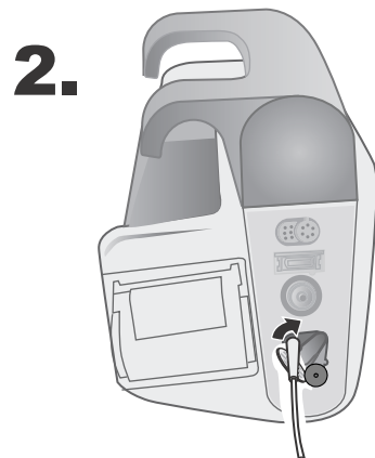
Figura 9-1 Conectarea conectorului tubului de eșantionare la portul de intrare pentru CO 2
