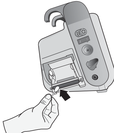
Figura 24-3. Curățarea capului de imprimare
