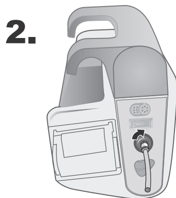
Figura 8-2 Conectarea unui furtun cu un singur lumen la unitatea X Series
