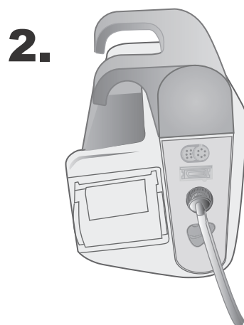
Figura 8-1 Conectarea unui furtun cu lumen dublu la unitatea X Series
